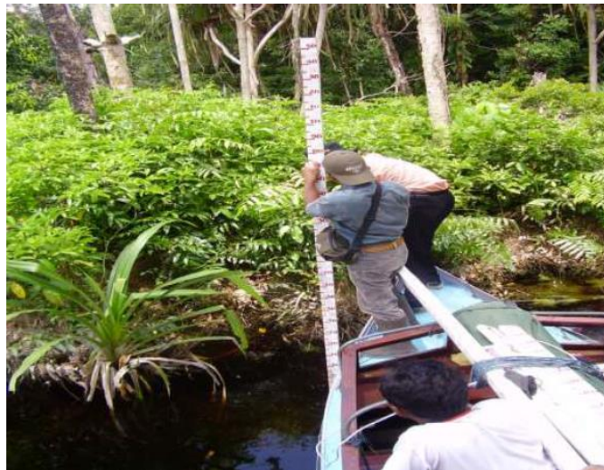
Pemasangan pengukur ketinggian air untuk mengukur fluktuasi ketinggian air.
